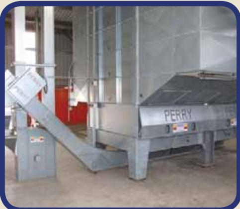
Для забезпечення постійного руху зерна всі зерносушарки серії Savannah оснащені нашим високопродуктивним повністю оцинкованим заслінковим механізмом вивантаження з пневматичним приводом (з втулками із фосфористої бронзи на всіх зношуючих частинах). Пневматичний заслінковий механізм вивантаження забезпечує рівномірний рух культури по всій основі. Це особливо важливо при сушінні культур з дуже високою вологістю, а також насіннєвих культур.
